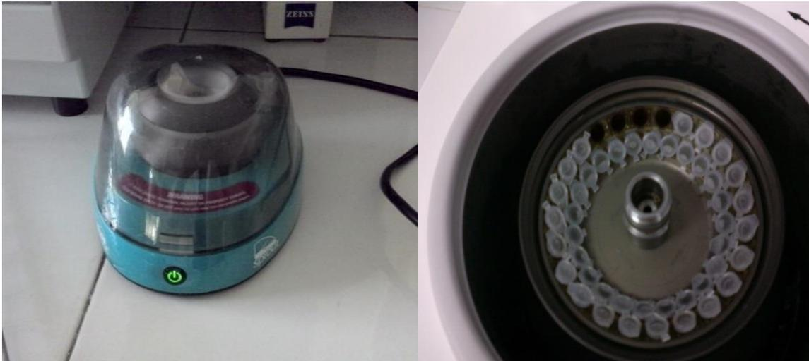
**Figura 5.** Centrifugado de las muestras de tejidos para realizar el recambio del fijador.
