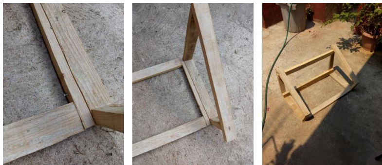
Figura 72. Ilustración de los pasos para el ensamblado de la estructura de horno solar.
