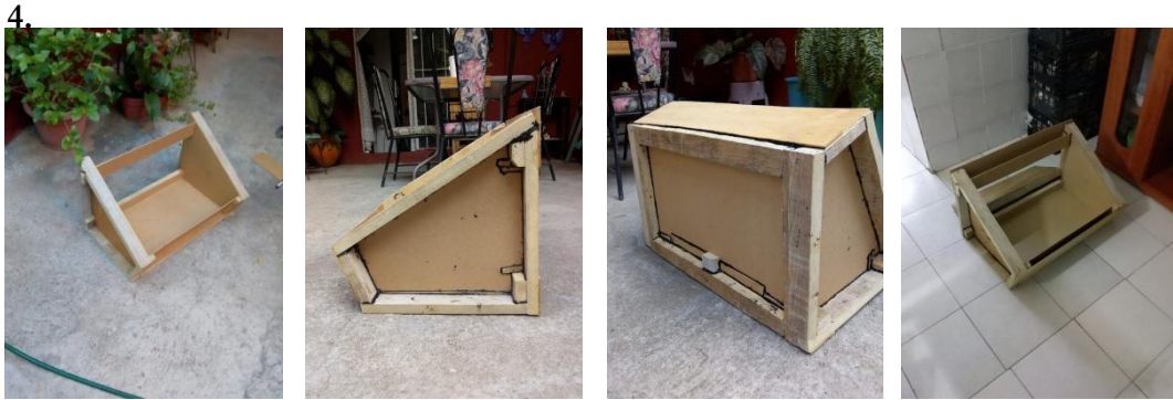
Figura 73. Ilustración de los pasos para colocación del revestimiento interior y silicón de alta temperatura a los marcos.
