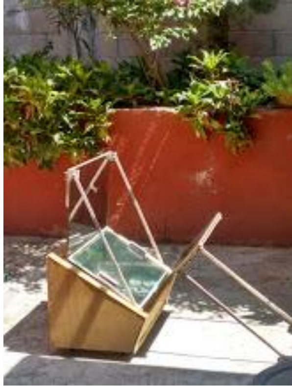
Figura 33. Horno solar ecológico, en construcción y pruebas.
