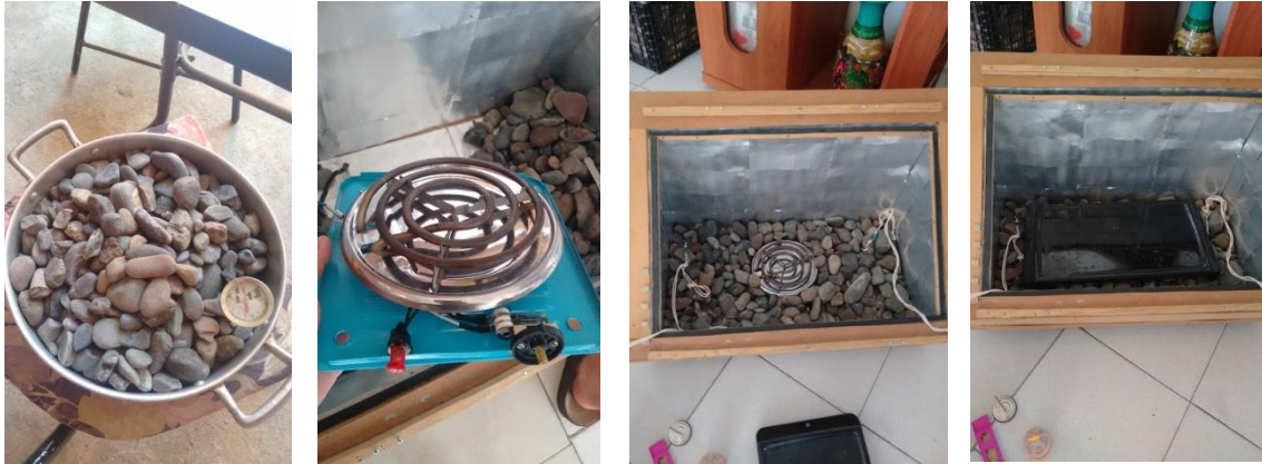
Figura 77. Piedras de río, resistencia eléctrica y placa negra absorbente
