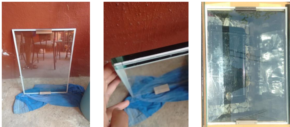
Figura 76. Imagen de un doble vidrio, separado por una cinta norton y agarraderas de aluminio.
