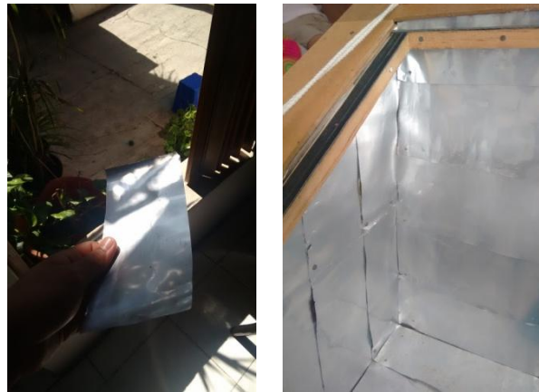
Figura 75. Imagen del revestimiento interior del horno solar ecologico forrado con hojas de aluminio reciclado (latas de refresco).
