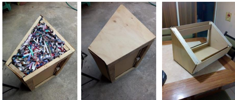
Figura 74. Imagen de los pasos para revestir el fondo de las paredes con aislante térmico (viruta de papel periódico y coco).
