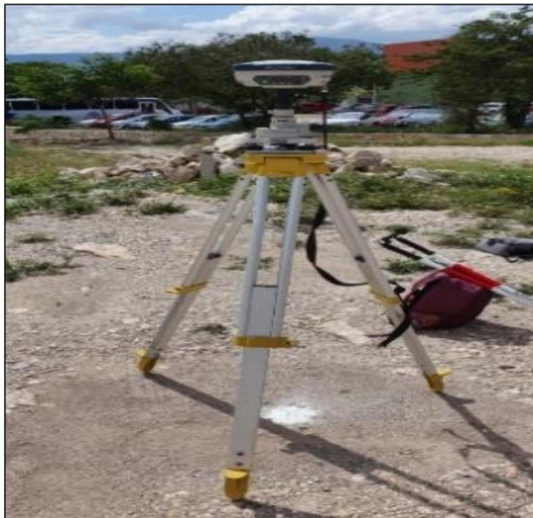
**Figura 8:** Estación base GPS RTK (Propia, 2019)
