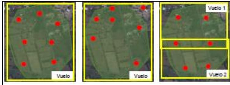
**Figura 17:** Distribución correcta de GCP (Zelaya, *et al*; 2016)
