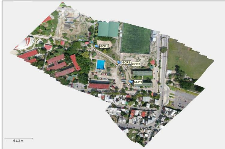
**Figura 52:** Orto mosaico de precisión (Adaptado de Agisoft PhotoScan, 2019)
