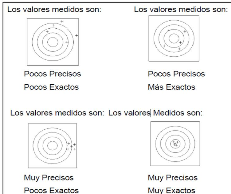
**Figura 6:** Ejemplos visuales de precisión y exactitud (Martínez, 2009)
