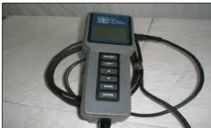
Figura 9. Multiparametrico YSI 85, medidor de temperatura, salinidad y oxígeno disuelto.
