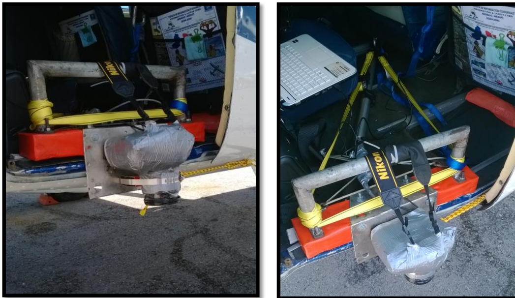
Figura 8. Montaje del equipo fotográfico en la aeronave.
