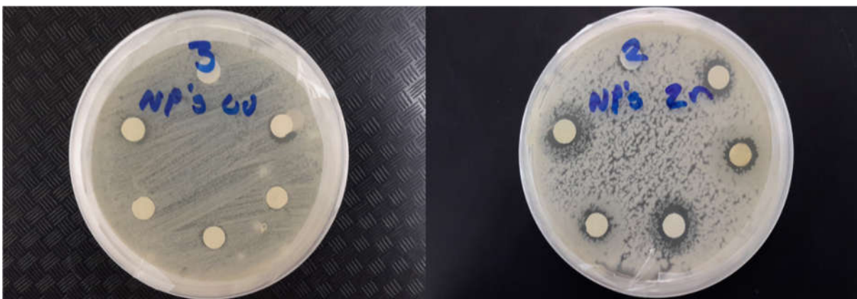
Figura 20. Evaluación de la inhibición bacteriana usando discos de difusión Baeur-Kirby en cepas bacterianas.
