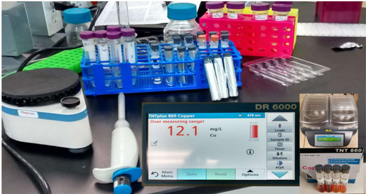
Figura 18. Alícuotas, digestión y lectura de las muestras en el espectrofotómetro, imagen (centro) de lectura en el espectro del extracto acuoso de Mezquite ( P. juliflora ).
