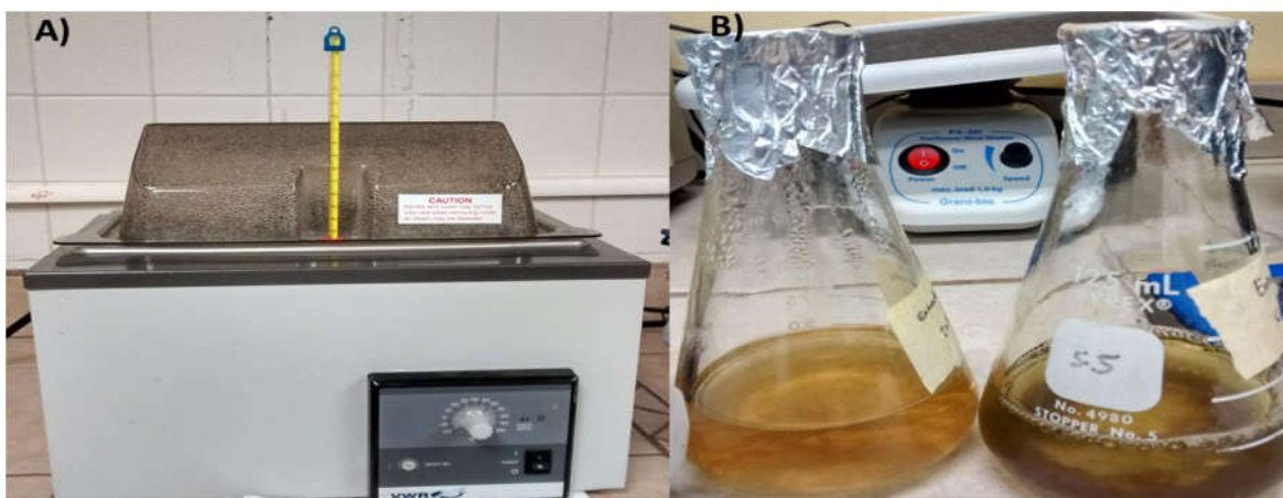
Figura 12. Baño maría durante la síntesis, y fitonanopartículas de mezquite y cachanilla.
