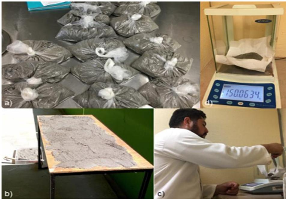
Figura 30. Procedimiento de análisis granulométrico: a) Muestras recolectadas de los diferentes sectores y zonas, b) Secado de las muestras, c) Pesado de muestras en balanza analítica y d) Peso de 150 g. para tamizado. Autor: Jesús Ezequiel Mejía Ruiz
