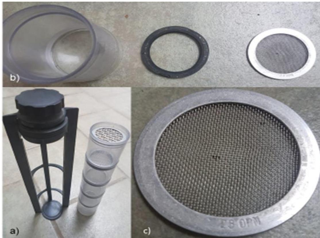
Figura 10. a) Armazón y cilindros apilados del *SandShaker*; b) Cilindro, empaque de espuma y malla y, c) Malla con borde de acero inoxidable 23 OPN (0.5842 mm)
