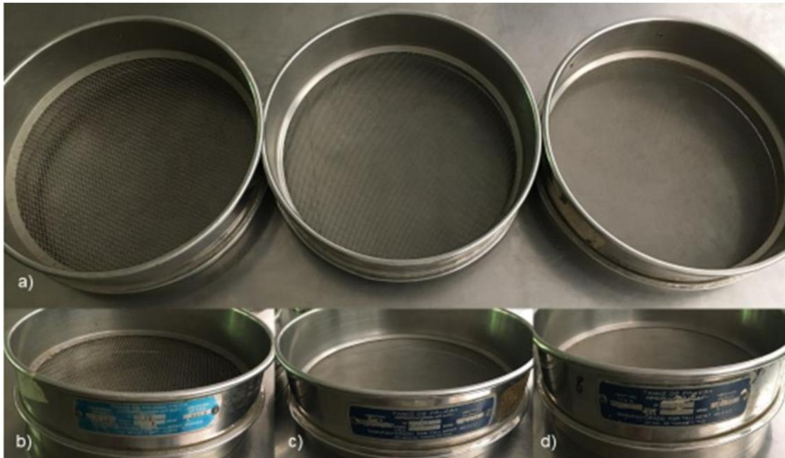
Figura 9. a) Tamices presentes en el Instituto de Ciencias Biológicas; b) Tamiz número 10 con apertura de 2 mm; c) Tamiz número 18 con apertura de 1 mm y, d) Tamiz número 30 con apertura de 0.595 mm
