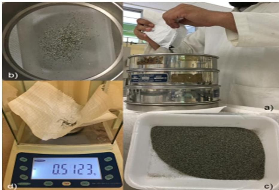
Figura 31. Proceso de tamizado a) Tamizado de 150 g. de arena, b) Granos retenidos en la malla No. 30, c) Granos de arena que pasó la malla No.30 y d) Peso retenido analizado en balanza analítica. (Ídem)
