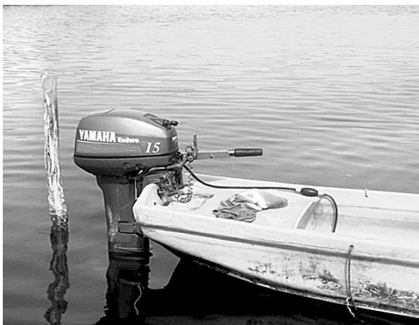
Figura 4 ■ | Pangas de fibra de vidrio impulsadas con motor fuera de borda.
