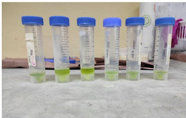
Figura 3-3. Extracción de lípidos.
