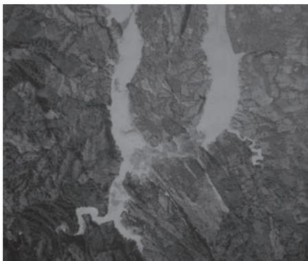
Figura 9. Taponamiento del río Grijalva por el desgajamiento de un cerro en Ostucán <sup>[15]</sup>.
