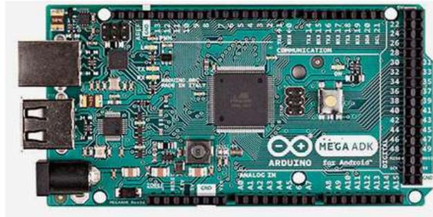
**Figura 2.17** Placa de Arduino Mega ADK [19].
