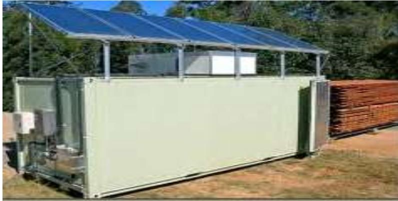
**Figura 1.2.** Secador híbrido solar gas natural [10].
