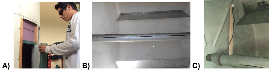
**Figura 3.5** Construcción de la cámara de secado, A) la puerta hermética, B) sistema de movimiento interno de los granos y C) eje trasversal de soporte con ranuras para la entrada de aire caliente. Fuente: propia.
