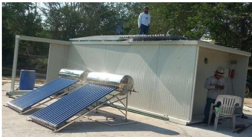
**Figura 1.6** Secador autónomo híbrido solar-gas LP automatizado [12].
