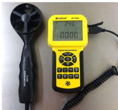
**Figura 3.18** Flow anemómetro.
