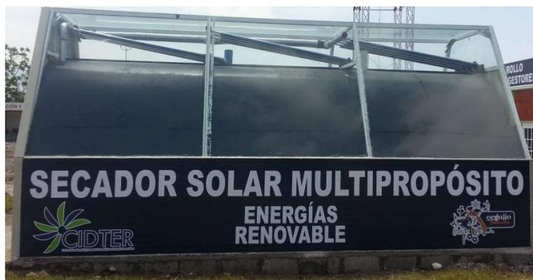
**Figura 1.5** - Secador solar multipropósitos semi-automatizado [11].
