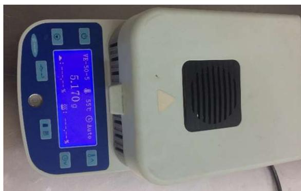
**Figura 3. 21** Balanza electrónica para medir humedad. Modelo VE-50-5.
