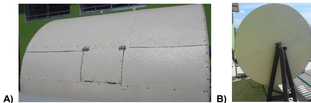
**Figura 3.6** – A) Puerta hermética junto con orificios de extracción de aire y B) Soporte de la cámara junto a la tubería de entrada de aire. Fuente: propia.
