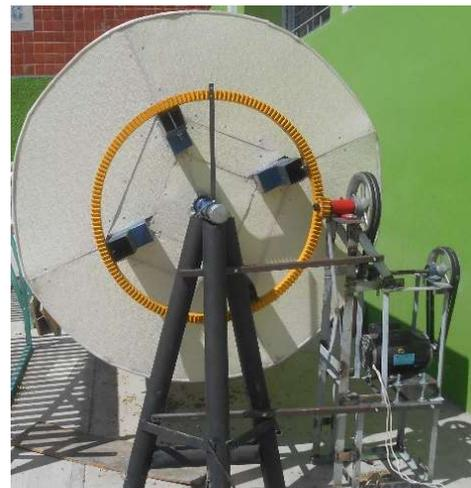
**Figura 3.11** Subsistema de transmisión movimiento.
