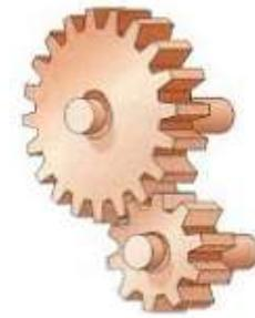
Los engranajes tienen la ventaja de que transmiten movimiento circular entre ejes muy próximos y además transmiten mucha fuerza (porque los dientes no se deslizan entre sí). La relación de transmisión ( $i$ ) en un sistema de engranajes se puede calcular del siguiente modo:
