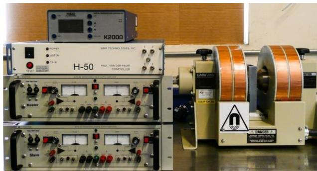
**Figura 1.2** Equipo de medición Hall MMR H50.
