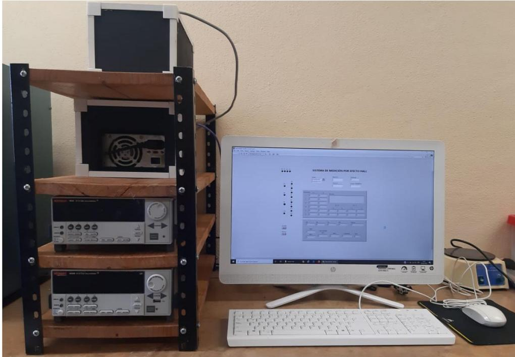
**Figura 4.16** Sistema de Medición de Efecto Hall instalado en el IIIER.
