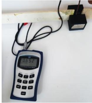
**Figura 4.10** Práctica de la medición de campo magnético respecto a la distancia de los imanes usando Teslámetro F. W. Bell modelo 5170.
