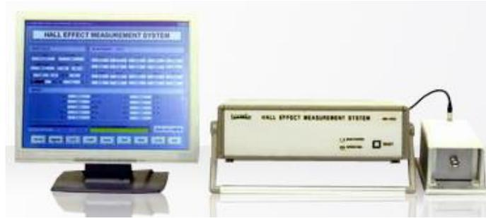
**Figura 1.1** Sistema de medición por efecto Hall (HMS) ECOPIA 3000.
