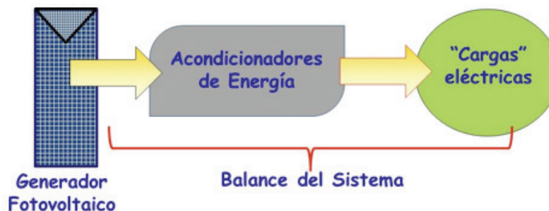
Figura 1.6.- Esquema básico de un Sistema Fotovoltaico.
