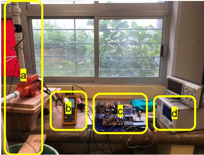
Figura 4.7. Sistema de bombeo conectado a convertidor, a) sistema de bombeo, b) Fluke 43b, c) Convertidor, d) Fuente Gwinstek APS-1102.
