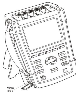
Figura 3. 18.- Equipo de medición de calidad eléctrica
