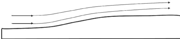
a) Escarpado de poca pendiente sin separación de flujo. [1]
