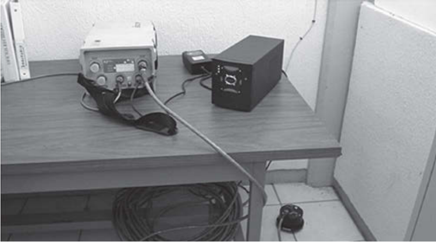
Figura 4. Equipo acelerométrico. La digitalizadora está conectada al sensor, empotrado al suelo. Se usa un no-break que permite disponer de cierto tiempo para guardar la información, en caso de un evento grande.
