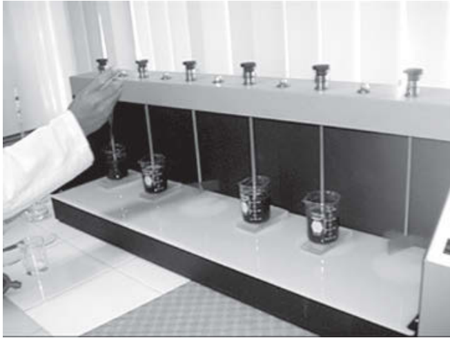
Fig. 3. Ensayos de coagulación-floculación en lixiviados maduros de Tuxtla Gtz.
