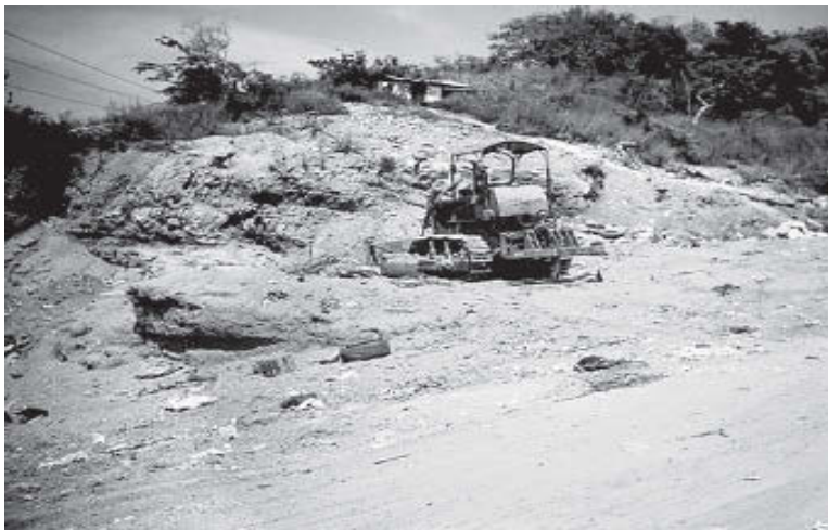
Foto 2. Tractor de tipo oruga D5, marca Komatsu, para labores del sitio
